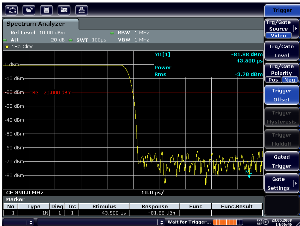
Bild 2-17: Fallende Flanke des GSM-Bursts mit hoher Zeitauflösung dargestellt
