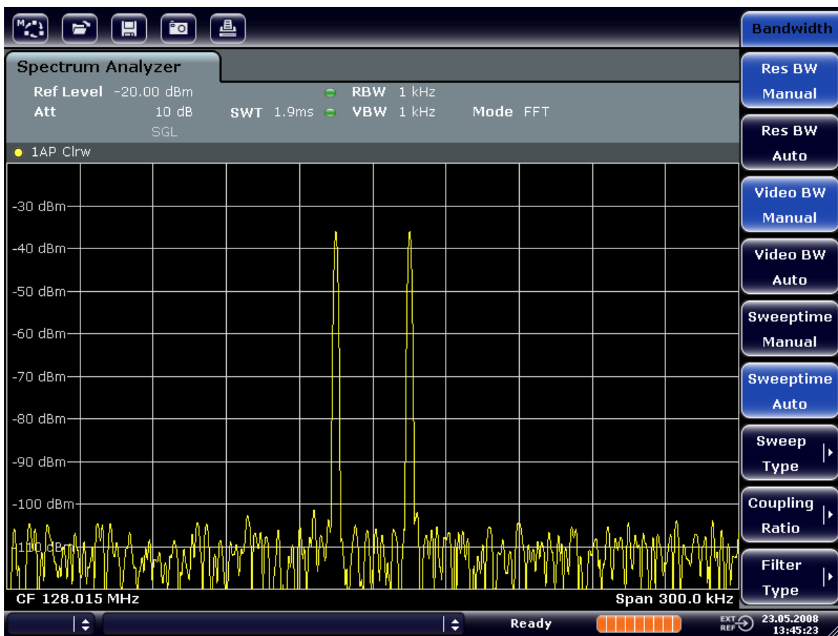
Bild 2-13: Messung von zwei HF-Sinussignalen gleichen Pegels mit einer Auflösungsbreite (1 kHz), die deutlich kleiner ist als der Frequenzabstand der Signale
